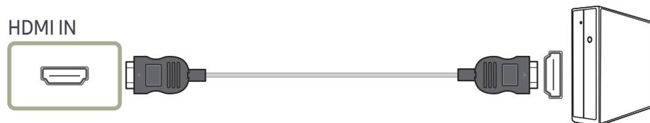
— Au moment de brancher le câble HDMI, utilisez le câble fourni avec les composants du produit. Si vous utilisez un autre câble HDMI que celui fourni par Samsung, la qualité de l'image risque de décroître.
