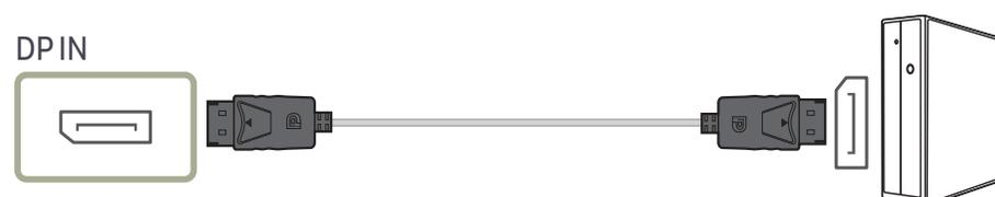
— Il est recommandé d'utiliser un câble DP d'une longueur inférieure à 1,5 m. L'utilisation d'un câble d'une longueur supérieure à 1,5 m peut affecter la qualité de l'image.
